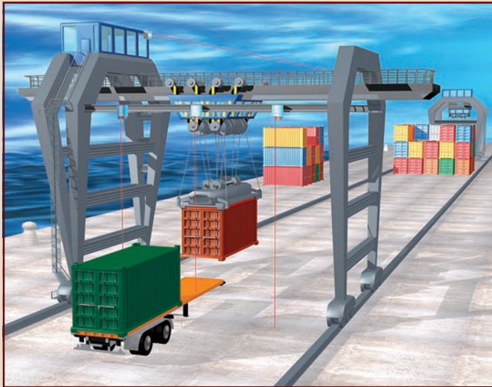
Deze 3D-tekening geeft mogelijke toepassingen weer voor laserafstandsensoren op portaalkranen.
