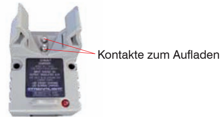
Abb. 4 Kontakte in der Ladestation
