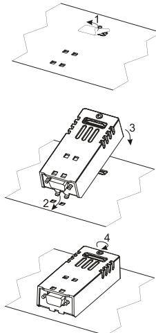
Remove the connector protective cover from the equipment before installing the module/ Entfernen Sie die Schutzabdeckung vor der Installation des Moduls/ Retirez le couvercle de protection du connecteur de l'appareil avant d'installer le module/ Retire la cubierta del conector de protección del equipo antes de instalar el módulo/ Rimuovere dall'apparecchiatura la protezione di copertura del connettore prima di installare il modulo.
