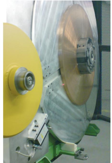
▲ In einer Umspulanlage werden aus einzelnen Metallbandringen fertige Coils oder Spulen erzeugt.
